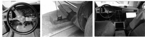
(a)方向盘 (b)转向轮图像记录模块 (c)实验车辆内部 图 5 改装后的车辆实验系统
