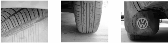
(a)转向轮俯视图 (b)转向轮前视图 (c)转向轮后视图 图 6 CCD 传感器在不同视角下获取的转向轮图像
